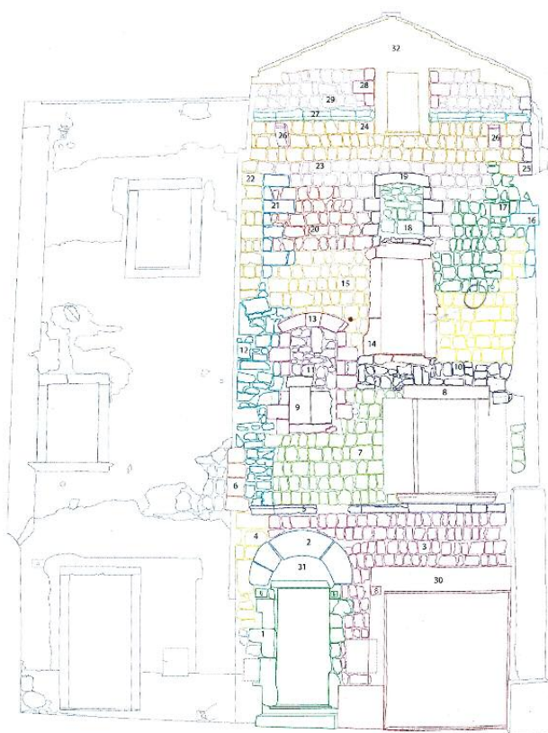
Fig. 9 - Fasi murarie della casa in via San Pietro.
